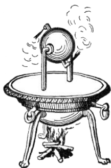
Aeolipile - Hero van Alexandria's stoommachine
