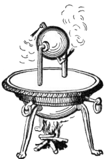
Aeolipile - Hero van Alexandria's stoommachine
